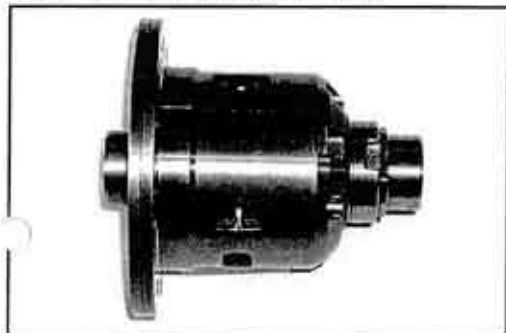
PHOTO N° 020533) Front LSD assembly
